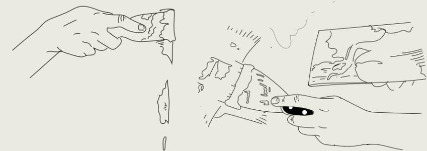
5. Después de aplicar el estuco y estando ya seco, utiliza una lija número 180 o superior para pulir la superficie y eliminar el material sobrante. Para finalizar, aplica pintura blanca del mismo tono de la pared. Recuerda dejar el espacio donde trabajaste limpio de residuos.
